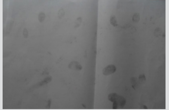
Şekil 1b Kağıt üzerine oluşturulmuş siyah manyetik toz ile görünürleştirilmiş parmak izi
