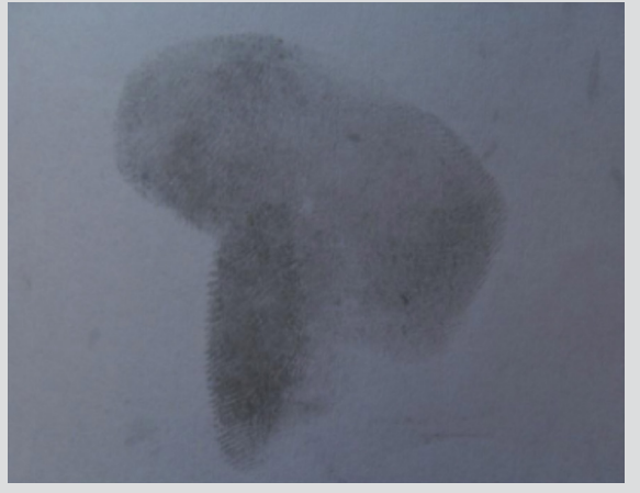
Şekil 1c Siyah manyetik toz ile görünürleştirilmiş sürüntü parmak izi
