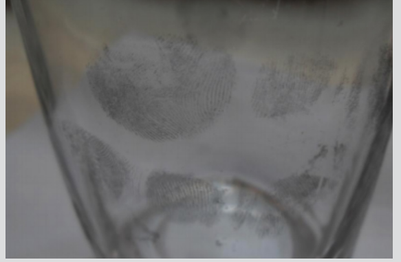
Şekil 1a Cam üzerine oluşturulmuş siyah manyetik toz ile görünürleştirilmiş parmak izi
